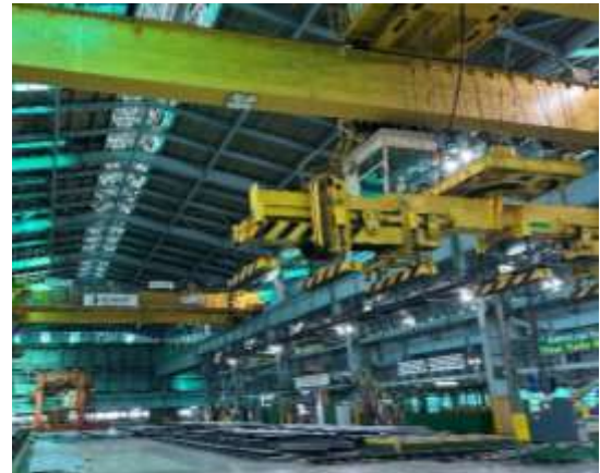
그림10. HHIP 판넬샵의 자동 마그네틱 크레인
