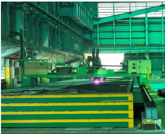
그림9. HHIP 판넬샵의 자동 플라즈마 절단기
